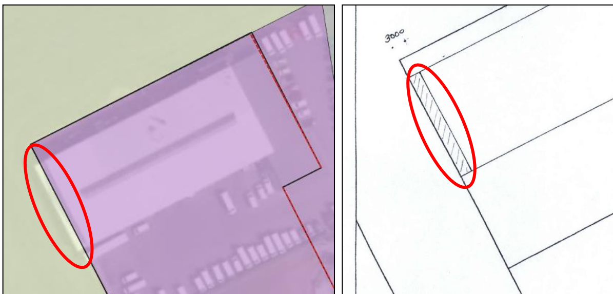
Links: uitsnede verbeelding vigerend bestemmingsplan "Kern Hooge Zwaluwe" ter plaatse van het perceel aan de Moerseweg 8. De verbeelding is gecombineerd met een luchtfoto. Zichtbaar is dat de uitbouw door het bestemmingsvlak en bouwvlak heen steekt. Rechts: kadastraal uittreksel met daarop weergegeven de uitbouw.
