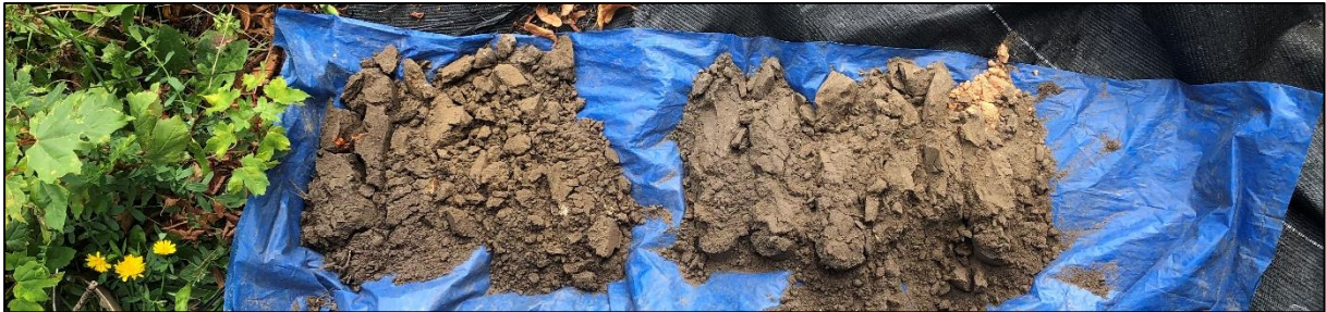
Boring 1: 0-100 cm -Mv. Boring 3 keer gestaakt in oranje/roze puin, mogelijk appelbloesembaksteen.
