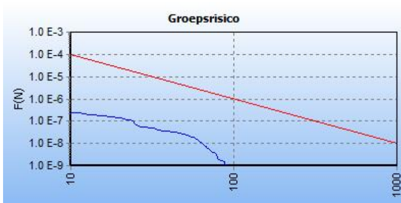
Afbeelding 6 fN-curve buisleiding Z-540-01-deel-1, huidige situatie
