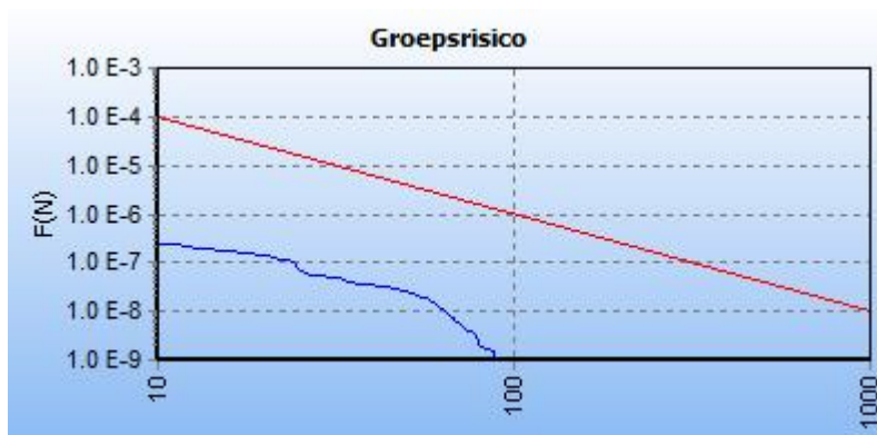
Afbeelding 8 fN-curve buisleiding Z-540-01-deel 1, toekomstige situatie
