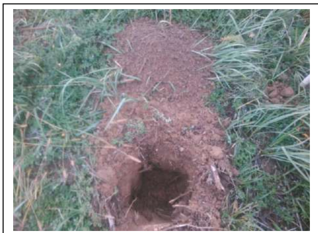
Foto 1. Opgegraven en gezeefd materiaal asbestinspectiegat 01
