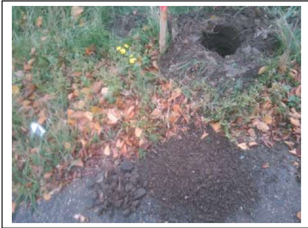
Foto 21. Opgegraven en gezeefd materiaal asbestinspectiegat 22
