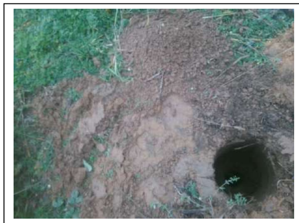
Foto 2. Opgegraven en gezeefd materiaal asbestinspectiegat 02
