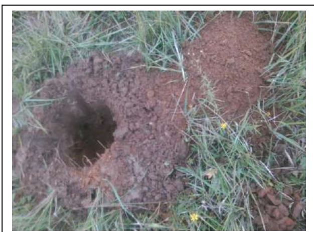
Foto 11. Opgegraven en gezeefd materiaal asbestinspectiegat 12
