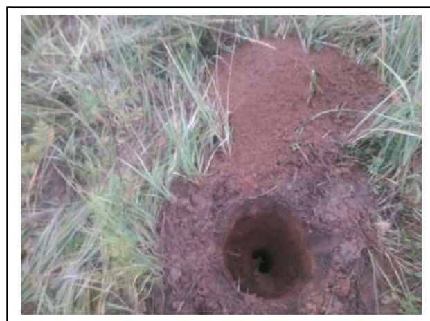
Foto 18. Opgegraven en gezeefd materiaal asbestinspectiegat 19
