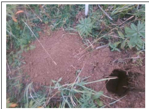
Foto 5. Opgegraven en gezeefd materiaal asbestinspectiegat 05
