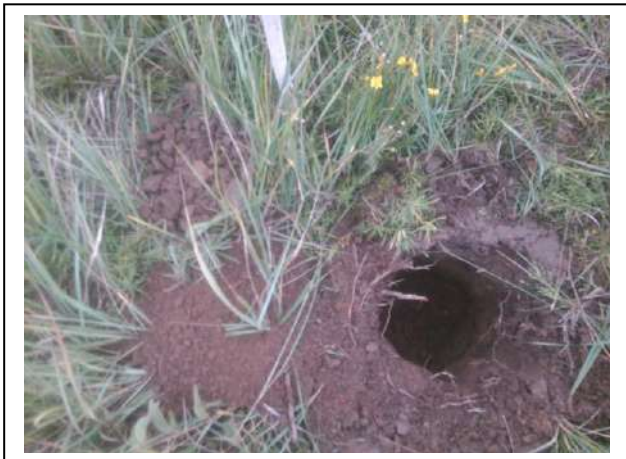
Foto 7. Opgegraven en gezeefd materiaal asbestinspectiegat 08
