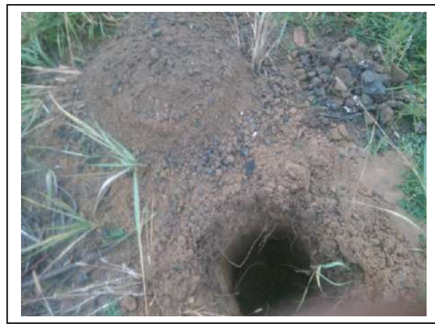
Foto 16. Opgegraven en gezeefd materiaal asbestinspectiegat 17
