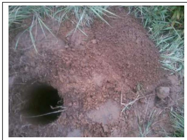
Foto 6. Opgegraven en gezeefd materiaal asbestinspectiegat 07
