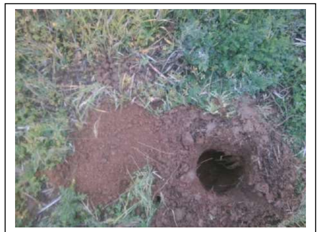
Foto 12. Opgegraven en gezeefd materiaal asbestinspectiegat 13
