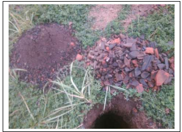
Foto 10. Opgegraven en gezeefd materiaal asbestinspectiegat 11
