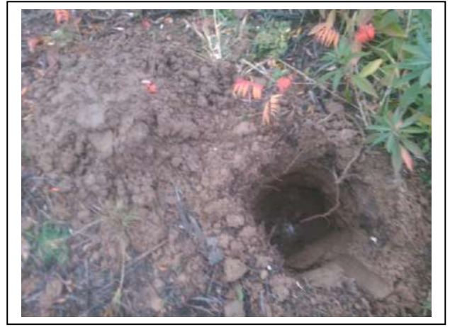
Foto 8. Opgegraven en gezeefd materiaal asbestinspectiegat 09
