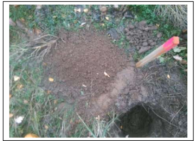
Foto 22. Opgegraven en gezeefd materiaal asbestinspectiegat 23
