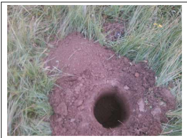
Foto 15. Opgegraven en gezeefd materiaal asbestinspectiegat 16
