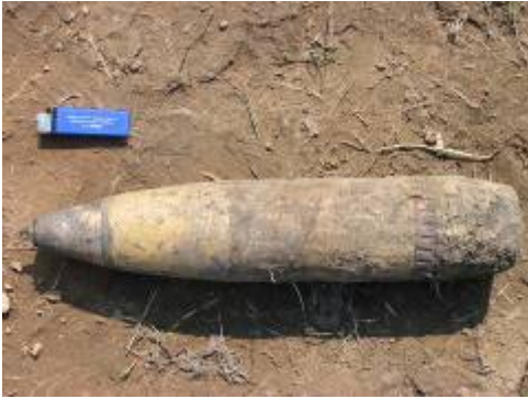
Afbeelding 8: Brisantgranaat van 25 Pdr.
