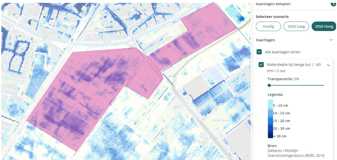
Figuur 4-5 Uitsnede klimaateffectatlas kaart Waterdiepte bij hevige bui 140 mm/2 uur met omkadering van projectgebied m.e.r.-beoordeling
