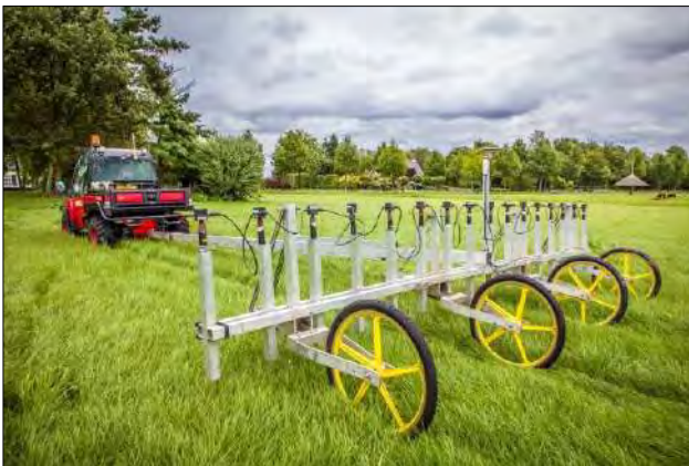
Figuur 30. Passieve non realtime oppervlakedetectie met het Vallon Multisondesysteem VVX16 en een staafdiagram waarop het maximale detectiebereik (m 2 - maaiveld) per kaliber is weergegeven.
