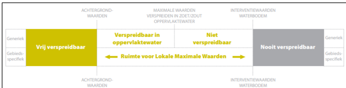
Figuur 5. Verspreiden van baggerspecie in zoet of zout oppervlaktewaterlichaam (T6 respectievelijk T7).
