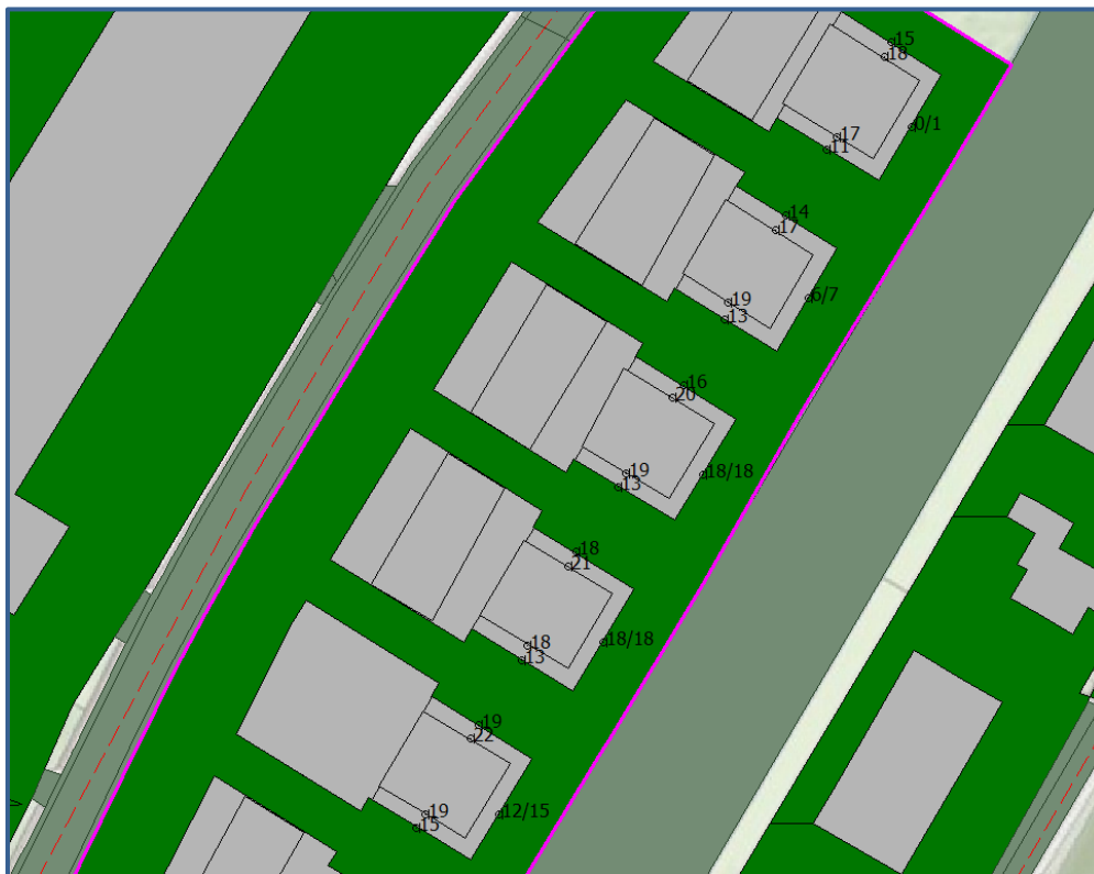
Afbeelding 8. Geluidbelastingen L_{den} (incl. aftrek art. 110g Wgh) Huizersdijk (5 noordelijke woningen) Berekende geluidbelastingen op een hoogte van 1,5 / 5,0 meter
