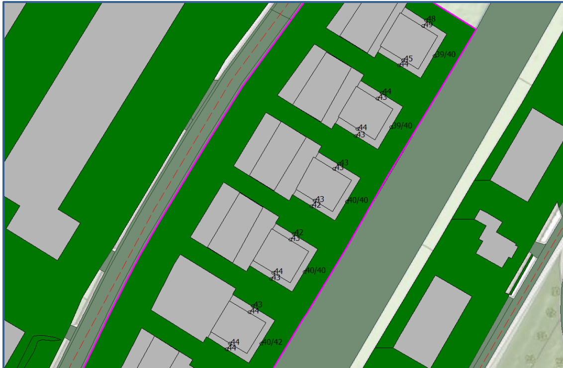
Afbeelding 14. Geluidbelastingen Lden (excl. aftrek art. 110g Wgh) cumulatief (5 noordelijke woningen) Berekende geluidbelastingen op een hoogte van 1,5 / 5,0 meter
