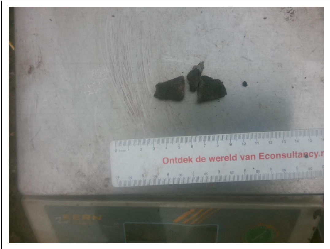
Foto asbestverdacht plaatmateriaal ASB04.
