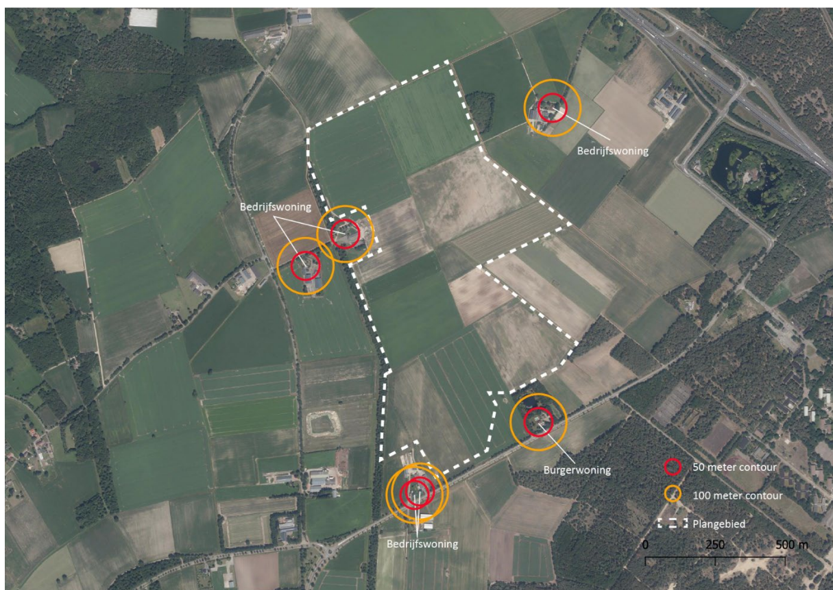
Figuur 202. Richtafstanden vanaf omliggende (bedrijfs- en burgerwoningen).
