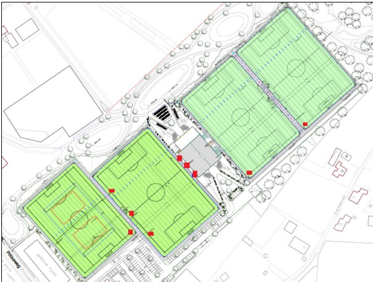
Figuur 3.3 Positie geluidsinstallatie.
