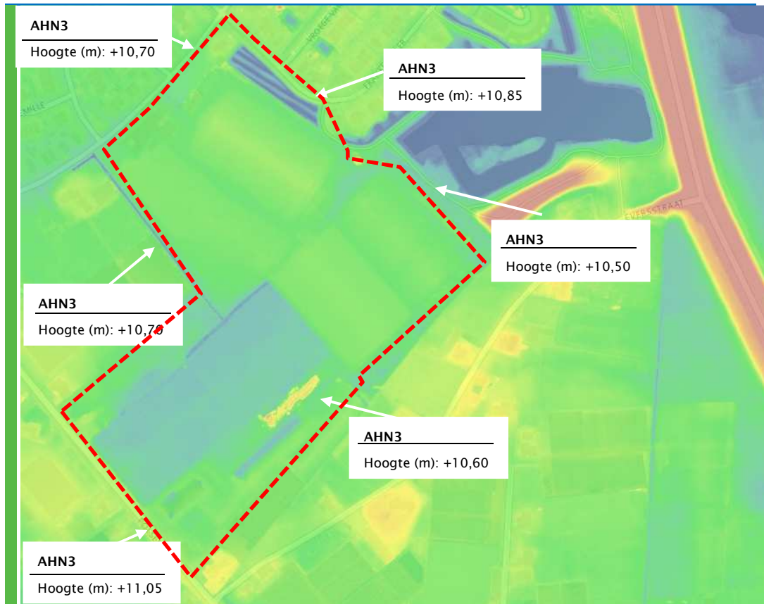
Figuur 2.2: Maaiveldhoogte projectlocatie, bron AHN3
