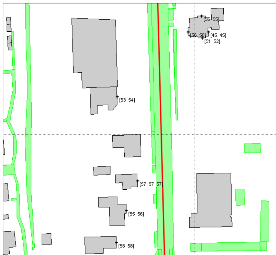
Figuur 8. Gecumuleerde geluidbelasting, excl. aftrek art. 110g Wgh (De Kazematten en het wegvak Karstraat tussen de Deellaan en de Kazematten uitgevoerd als SMARDpave)
