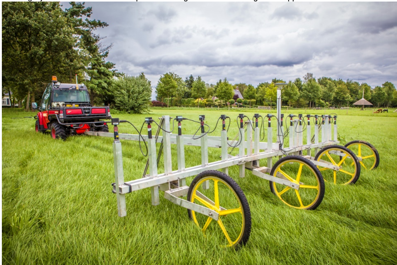
Afbeelding 2. Detectievoertuig zoals deze gebruikt is voor het uitvoeren van de passieve computerondersteunde oppervlakedetectie.
