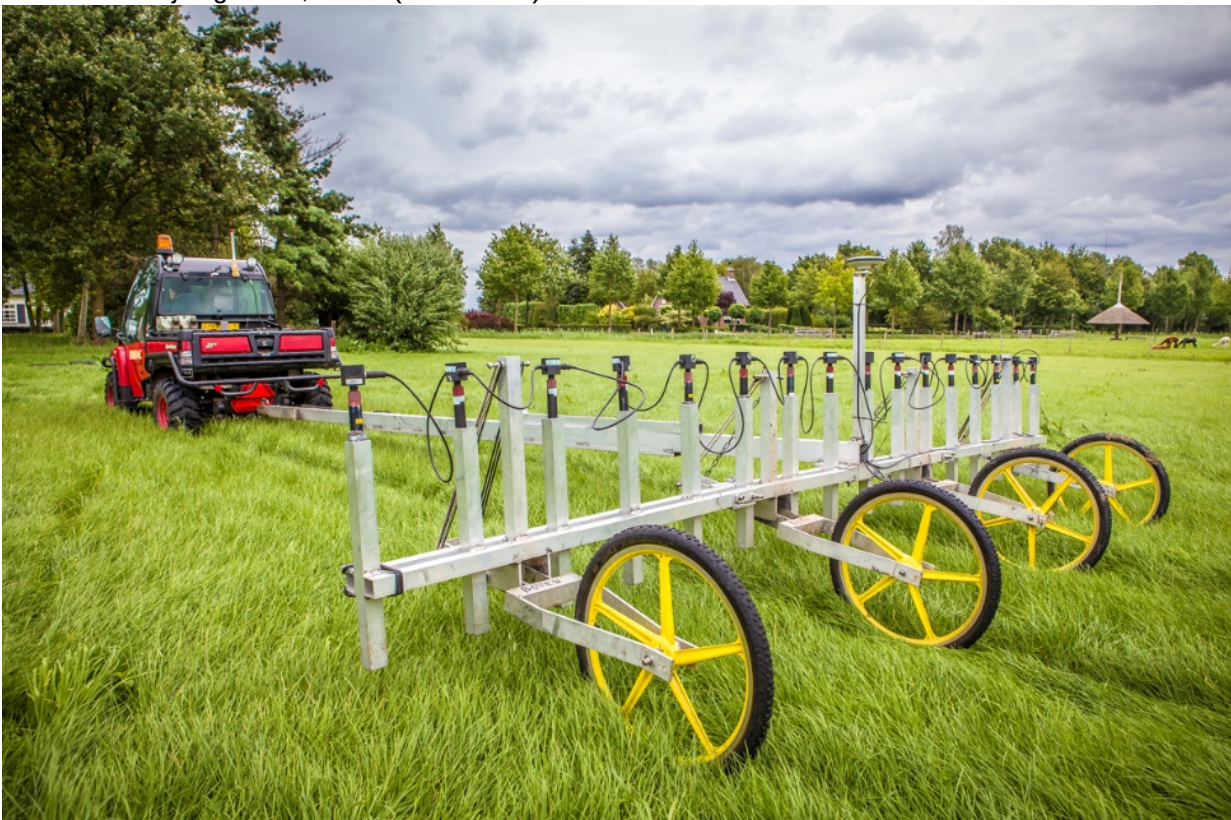
Afbeelding 3. Vallon Multisondesysteem VXV16 gemonteerd achter een trekkend voertuig (in dit geval een John Deere).
