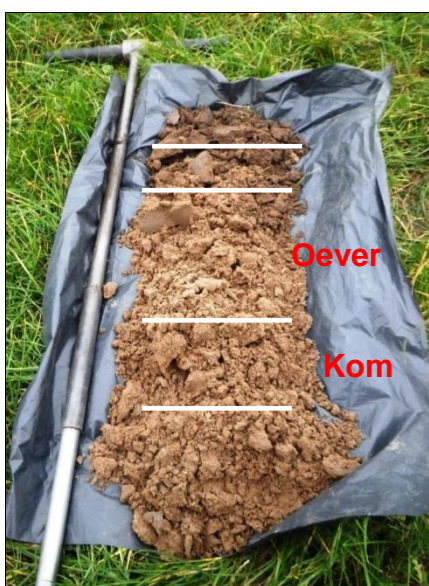
Afbeelding 4. Beeld van boring 9 met van boven naar beneden de bouwvoor, zwak zandige klei, matig grof zand, sterk siltige klei en matig fijn zand
