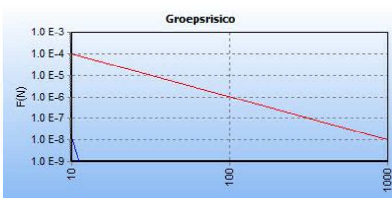
Figuur 2.4: fN-curve buisleiding N-500-15-deel-1
