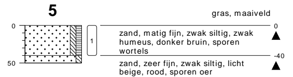
type grondboring datum 24-05-2017 boormeester Jan Hartman
