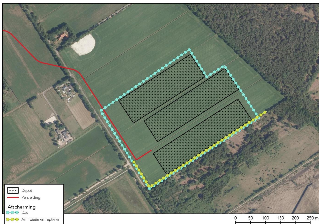
Afbeelding 7 Benodigd scherm voor amfibieën en reptielen en dassenraster.
