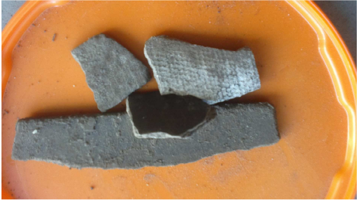
Foto 3. Asbestverdacht plaatmateriaal achter Oostindië 54, Nieuw-Roden
