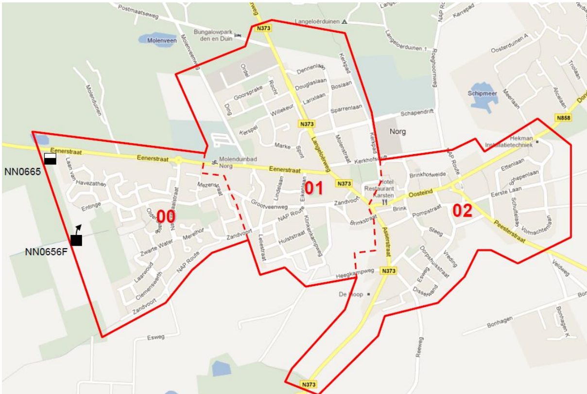
Figuur 3.4. Stuwgebieden riolering Norg met gemaal (NN0665) en overstort (NN0656F) met randvoorziening (450 m 3 ) en aanvullende berging (2100 m 3 ). Bron: BRP Norg door Grontmij Nederland, d.d. 28 februari 2012 met projectnummer 261230. De planontwikkeling Oosterveld ligt direct oostelijk van gebied 02.
