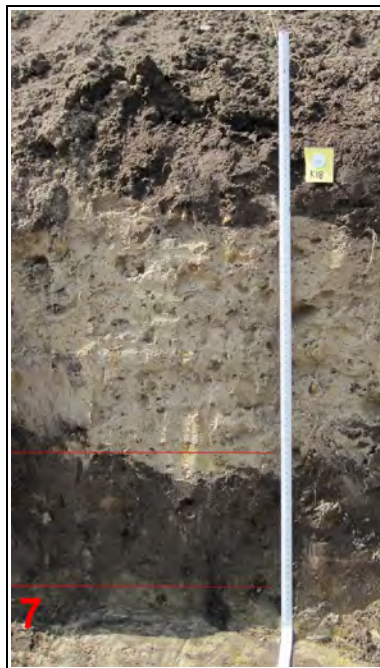
Figuur 10 Roden, Westeresch: kolom 18 uit proefsleuf 7. De situatie is hetzelfde als in proefsleuf 6. Het ophogingspakket is duidelijk te zien. Eronder, tussen de rode lijnen, is de oude bouwvoor te zien tussen de rode lijnen.
