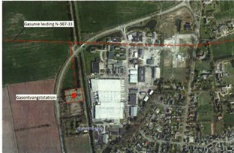
Figuur 5.1: situering gasleiding (rode stippellijn) en gasontvangstation
