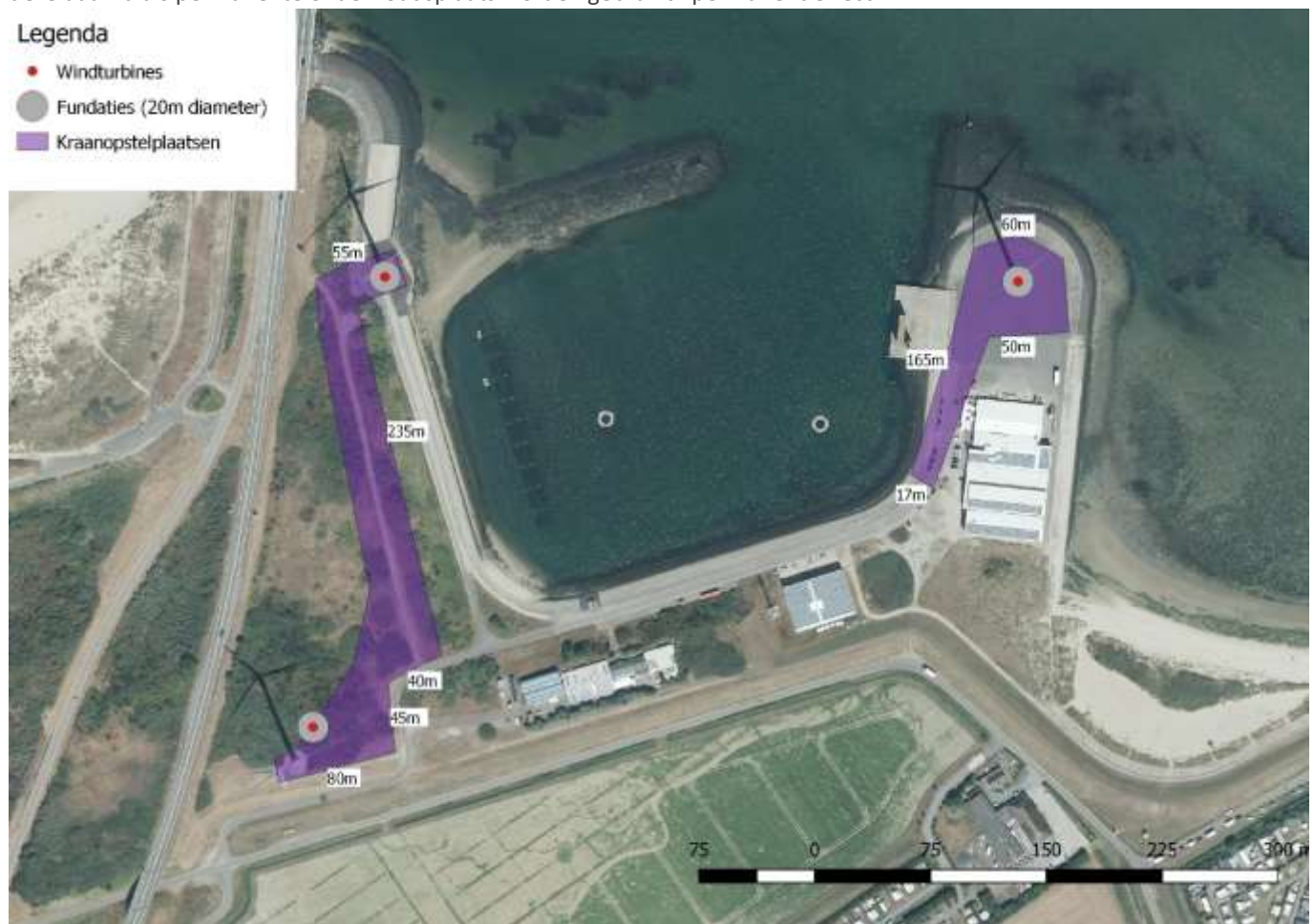
Figuur 2.4 Geplande kraanopstelplaatsen Windpark Jacobahaven
