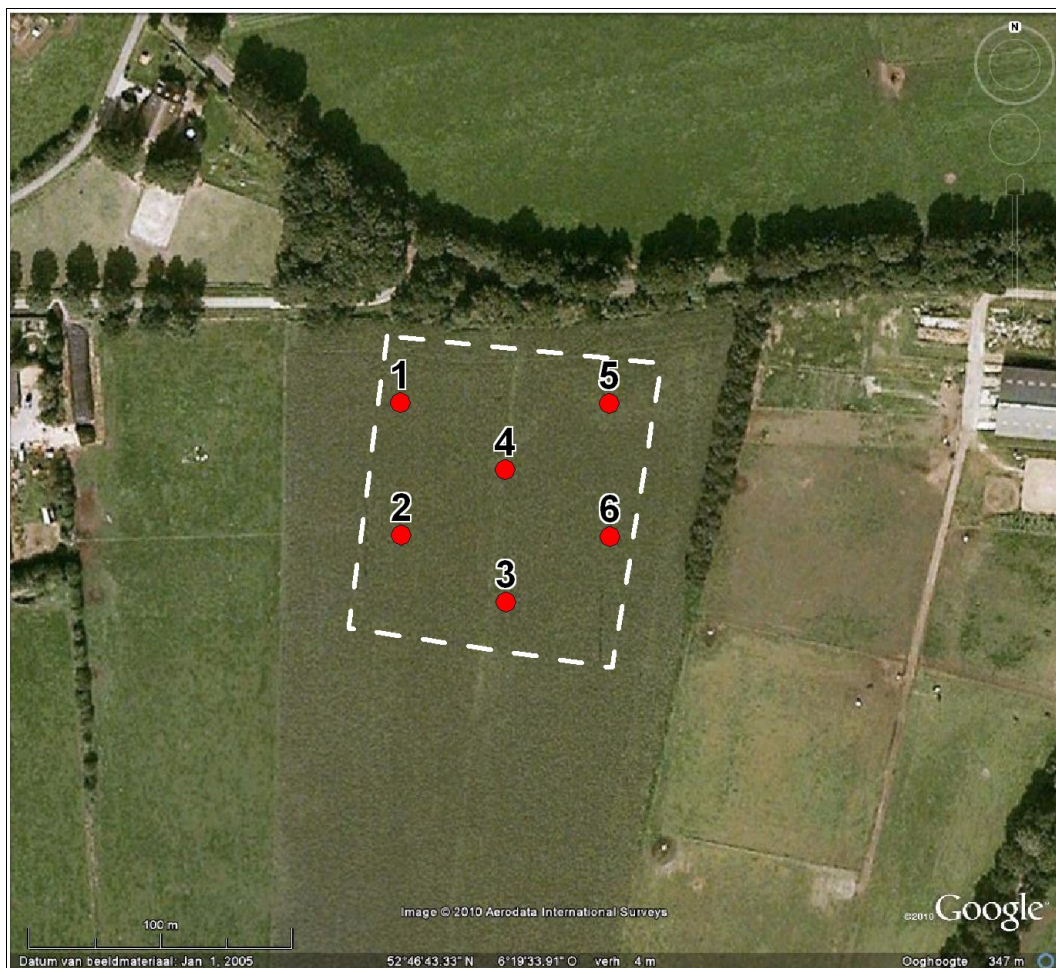
Figuur 6: Ansen, Om de Kamp: boorpuntenkaart. Het plangebied is aangegeven door een onderbroken witte lijn. De genummerde punten geven de ligging van de boringen weer.
