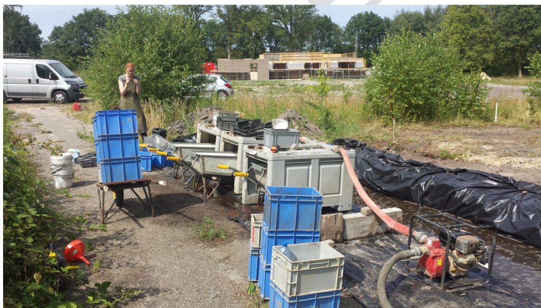
Afb. 8. Zeefput en zeefinstallatie in het veld om direct alle grondmonsters te kunnen zeven.
