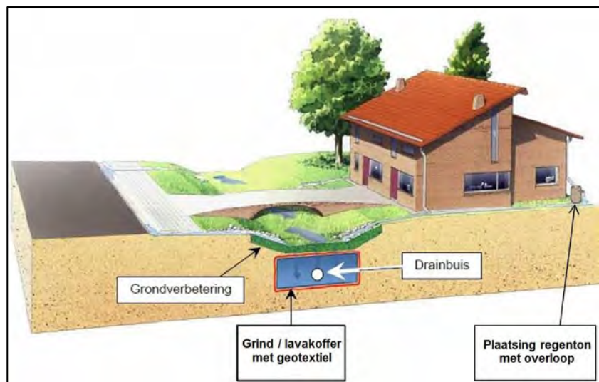
Afbeelding 8: Principe wadi [bron: Wadi's: wat wel en wat niet? Gemeente Wierden]
