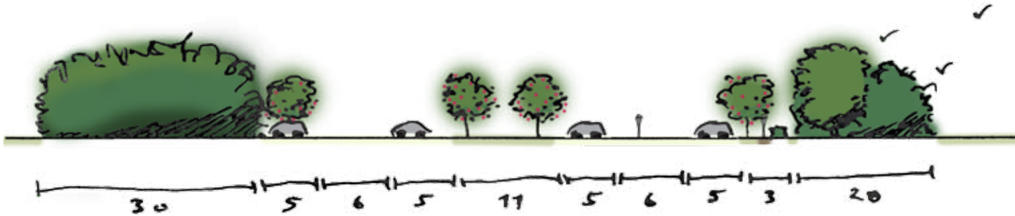
Doorsnede parkeerplaats en houtwal
