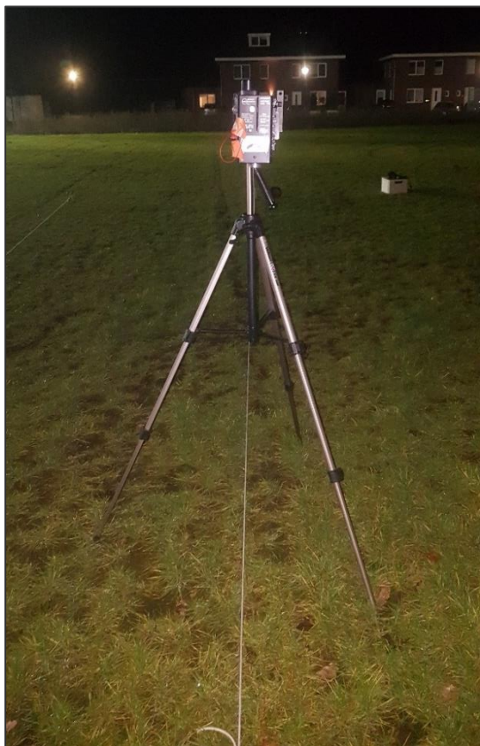
Figuur 6 Meetopstelling photometer en luxmeter
