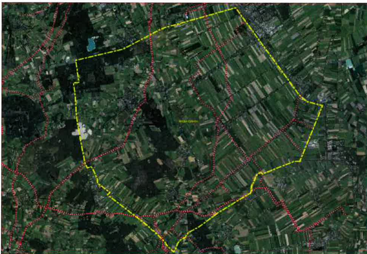
Figuur 3. Ondergrondse hogedruk aardgasleidingen Gasunie en NAM
