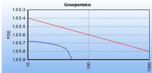
Figuur 5.4: fN-curve v/h berekende groepsrisico (blauwe lijn) met de oriëntatiewaarde (rode lijn) A-503
