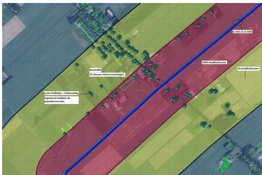
Figuur 5.1: situering gasleidingen (blauw) en invloedsgebieden van de gasleiding (rood=100% letaliteit en geel=1% letaliteit)
