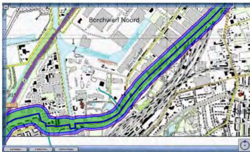
Figuur : De plaatsgebonden risicocontour van de leiding Z-529-03 (groene contour is de PR 10 -7 , paars is de 10 -6 )
