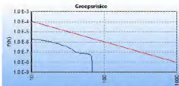
Figuur : FN curve behorend bij de boven aangegeven kilometer leiding in de huidige situatie . bedraagt < 0,038 * de oriënterende waarde
