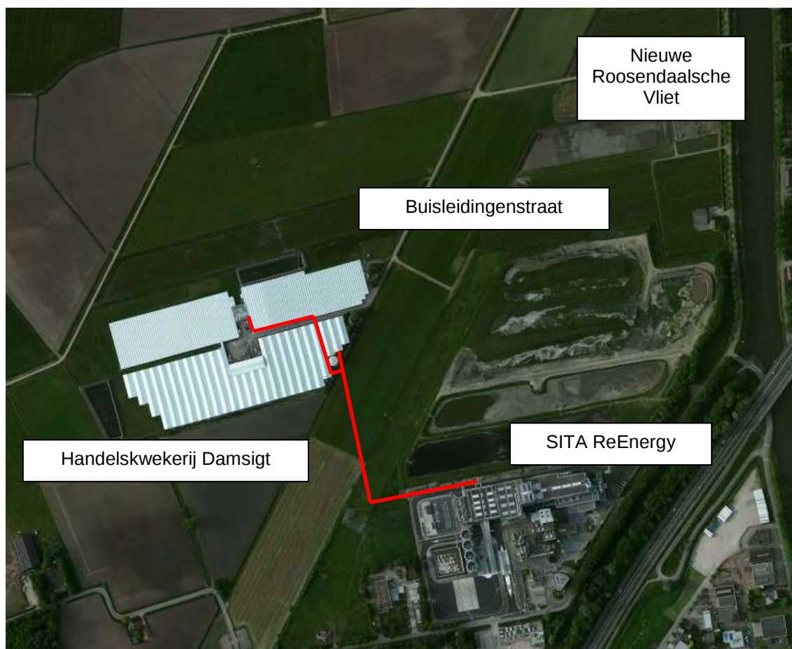
Afbeelding 5: Luchtfoto van huidige kwekerij te Roosendaal met restwarmteleiding
