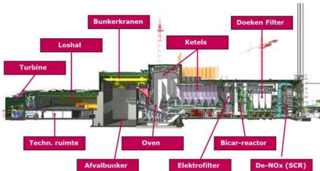
Afbeelding 25: illustratie van proces van afvalverwerking en energieopwekking
