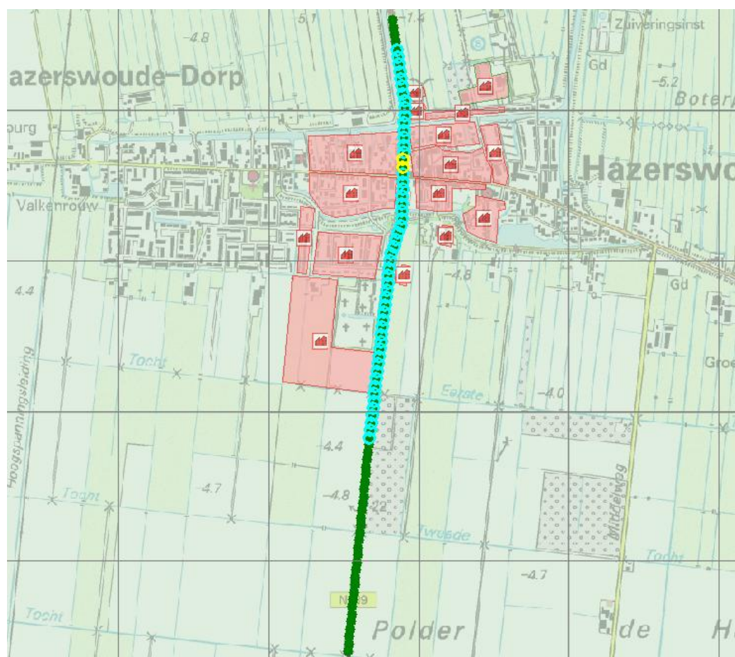
Figuur 4. Kilometer hoogste groepsrisico N209 voor de toekomstige situatie, gridgrootte is 500 meter
