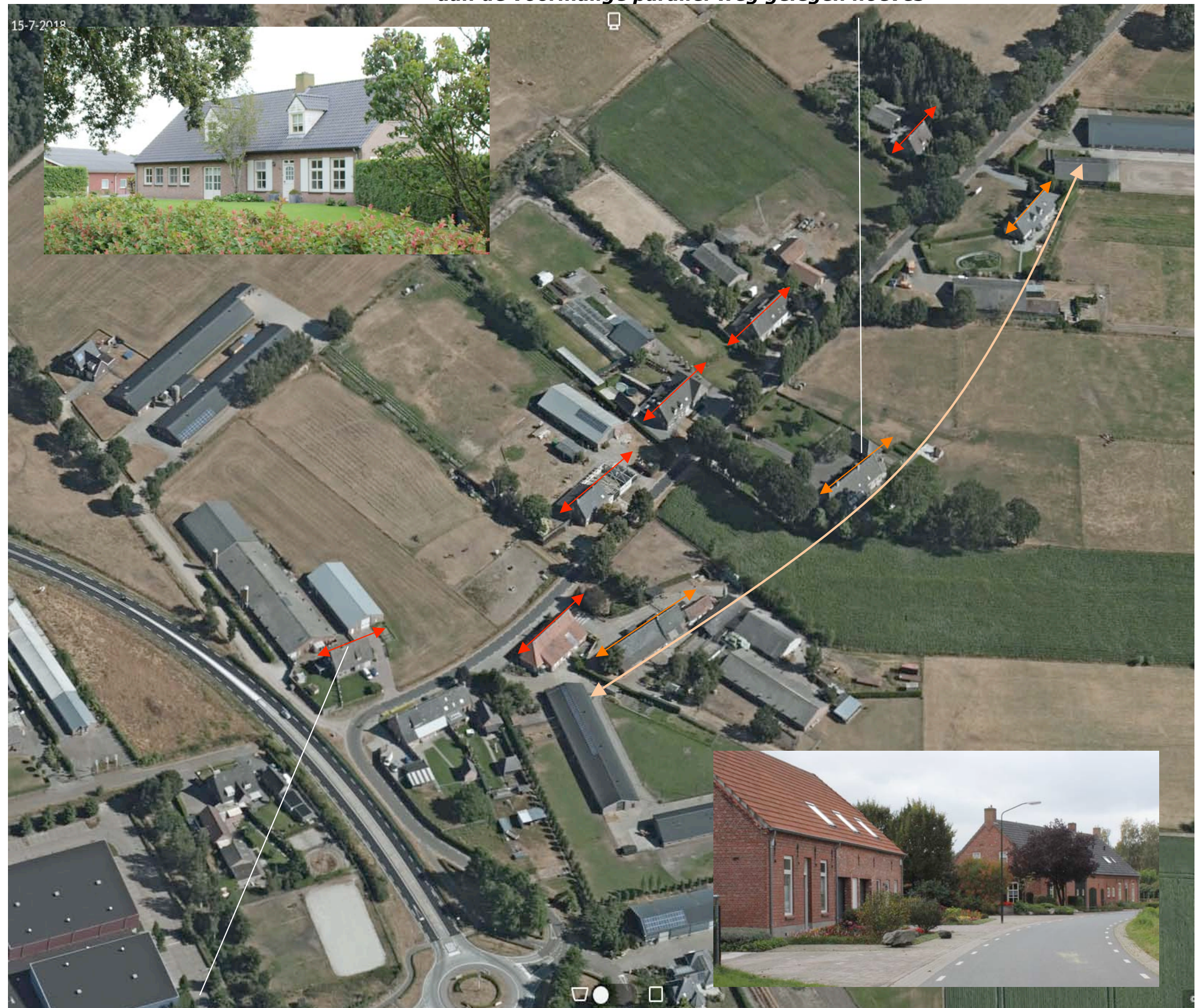
langgerekt volume, 1 verdieping met kap, nok parallel aan de huidige weg, op wisselende afstand van de weg
