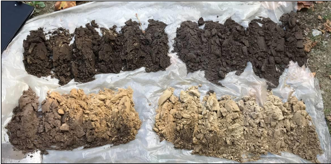
Figuur 12: Het boorprofiel van boring 3. De leesrichting is van links naar rechts (0-200 cm -mv).
