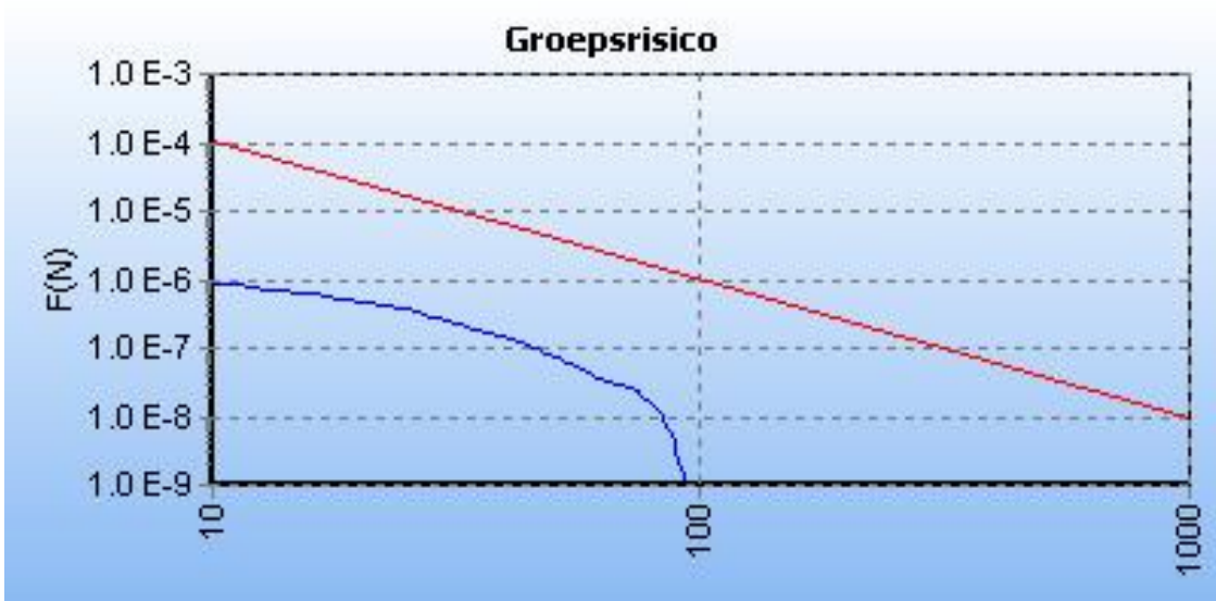
Figuur 4.3. FN curve voor {12D85F6C-A3BF-4199-A7A1-C54DD6FAD700}_000108 van Nederlandse Aardolie Maatschappij BV voor de kilometer tussen stationing 7650.00 en stationing 8650.00
