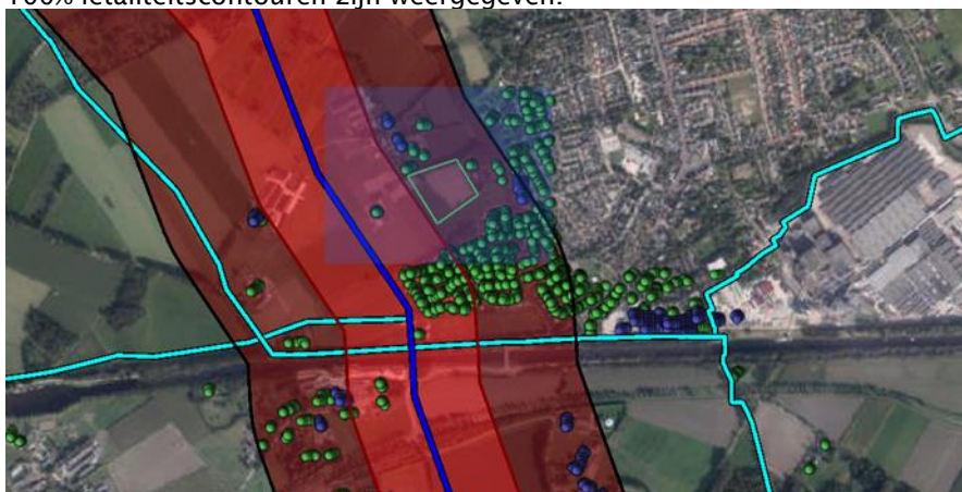
Figuur 2.4 1% en 100% letaliteitcontour van hogedruk aardgasleiding A-521deel 1 ter plaatse van de geplande ontwikkeling, plangebied gelegen binnen 1% letaliteitscontour
