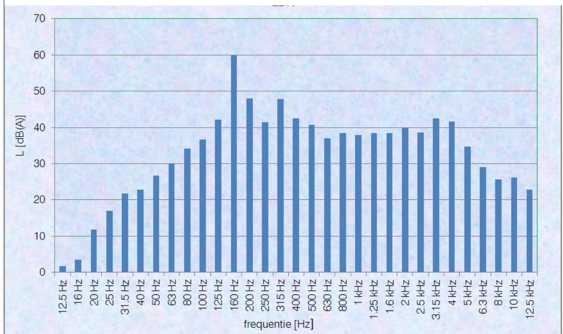
Grafiek 2-1: geluidniveau nabij gedempte luchtbehandelingskast.
