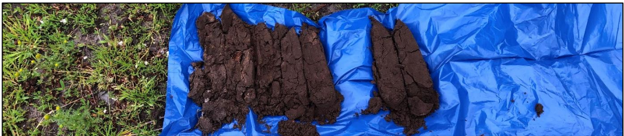
Boring 5: 0-70 cm -Mv. Meermaals gestaakt in puinpakket.
