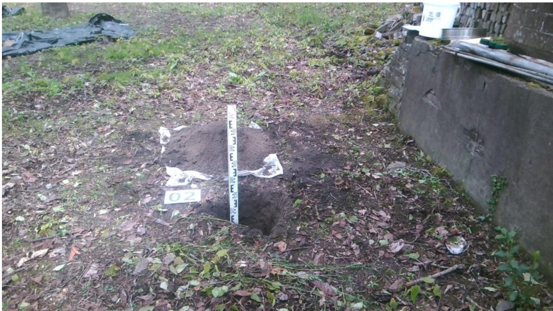
Afbeelding 10: opgegraven grond inspectiegat IG02
