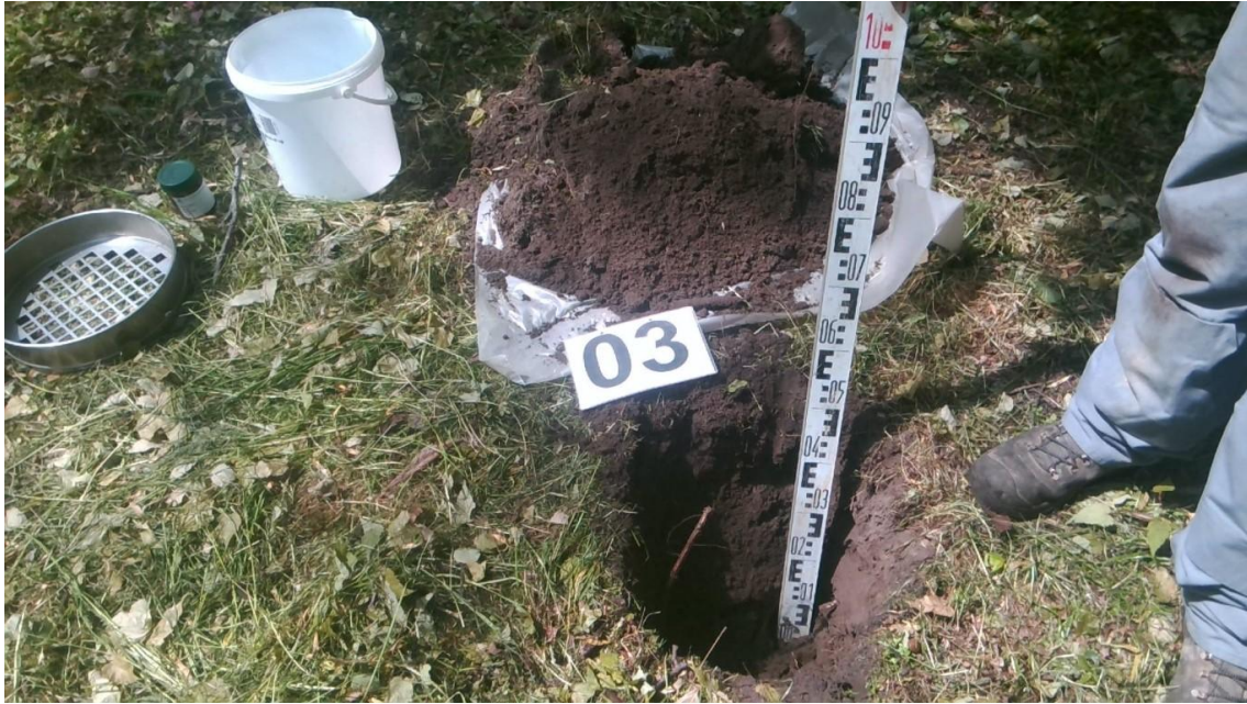
Afbeelding 11: opgegraven grond inspectiegat IG03
