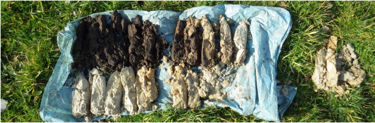
Opname van boring 8. Verteerd veen onder een ophoogpakket. Onder het veen liggen fluvioperiglaciale afzettingen
