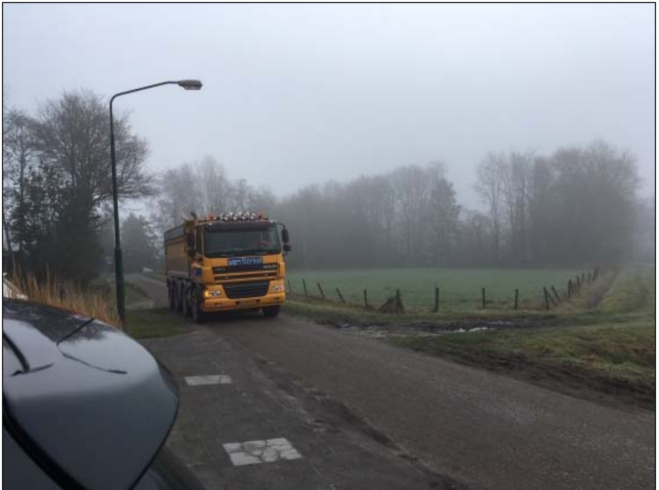
Figuur 3.1: Gebruikte vrachtwagen als trillingsbron met bijna 39 ton totaal gewicht
