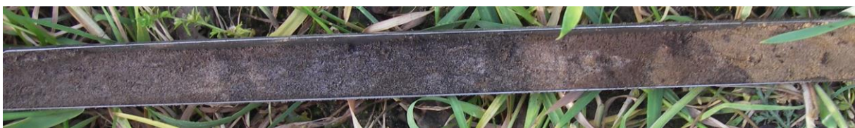
Figuur 13: Foto van boring 3 met helemaal rechts het matig fijne, zwak lemige, zwak geoxideerd zand, links hiervan een dun laagje sterk veraard, zandig veen, verder naar links de afgedekte, enigszins moerige, bouwvoor en hier weer rechts van, het matig humeuze zand.
