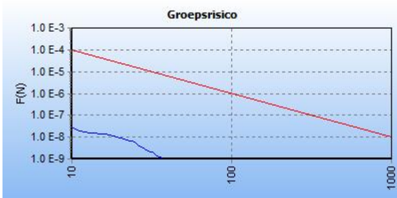
Figuur 5.1 FN curve voor 6919_leiding-Z-529-27-deel-1 van N.V. Nederlandse Gasunie voor de kilometer tussen stationing 2470.00 en stationing 3470.00
