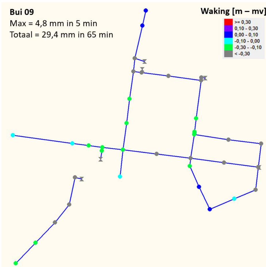
Figuur 11 Waking HWA-riolering Smartpark Gemert bij bui 09. De verschillende kleuren geven de hoeveelheid waking aan. Een positieve waking duidt op water op straat.
