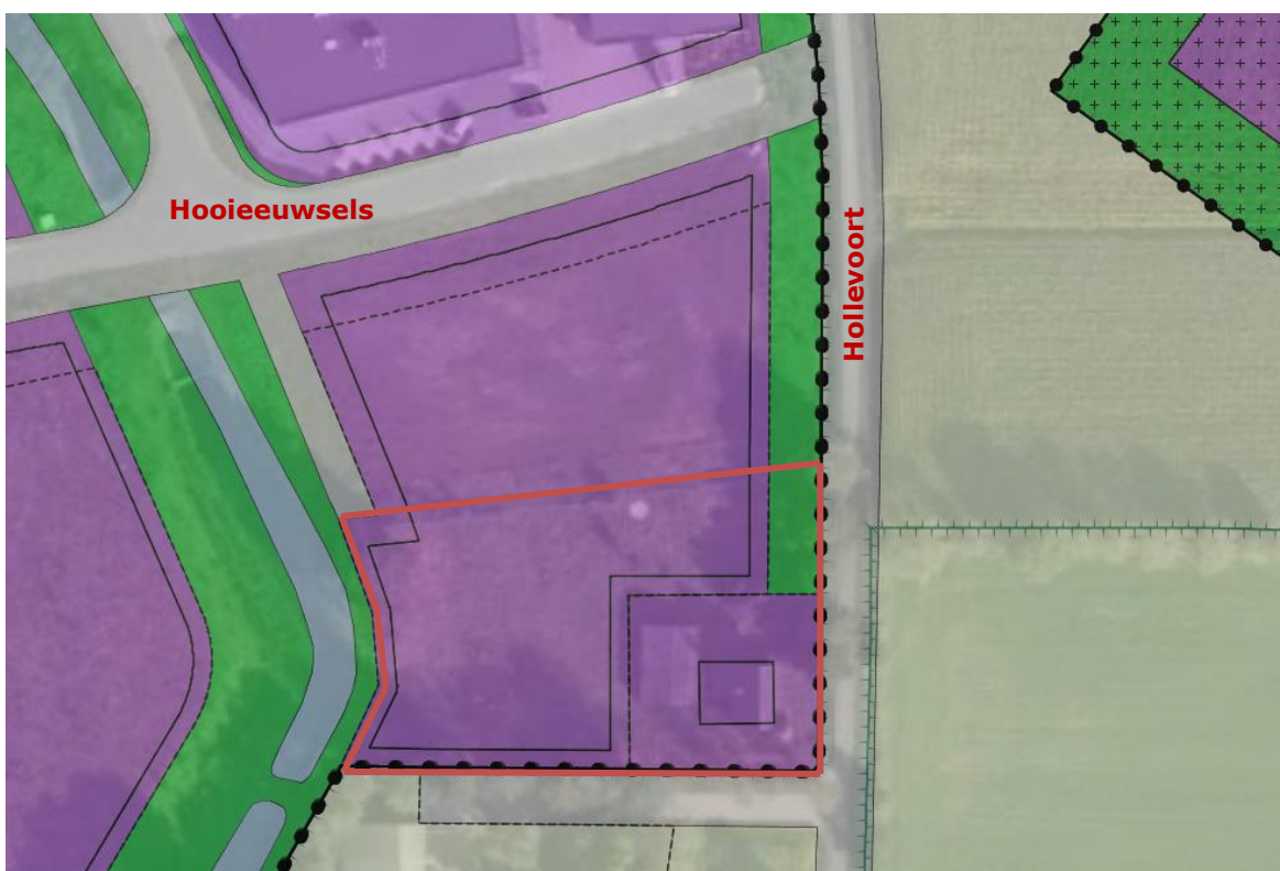
Figuur 2 Vigerend bestemmingsplan 'Herziening bedrijventerreinen Bolle Akker 2013'. Het plangebied is roodomlijnd. Paars is 'Bedrijf', groen is 'Groen', grijs is 'Verkeer', lichtblauw is 'Water'.
