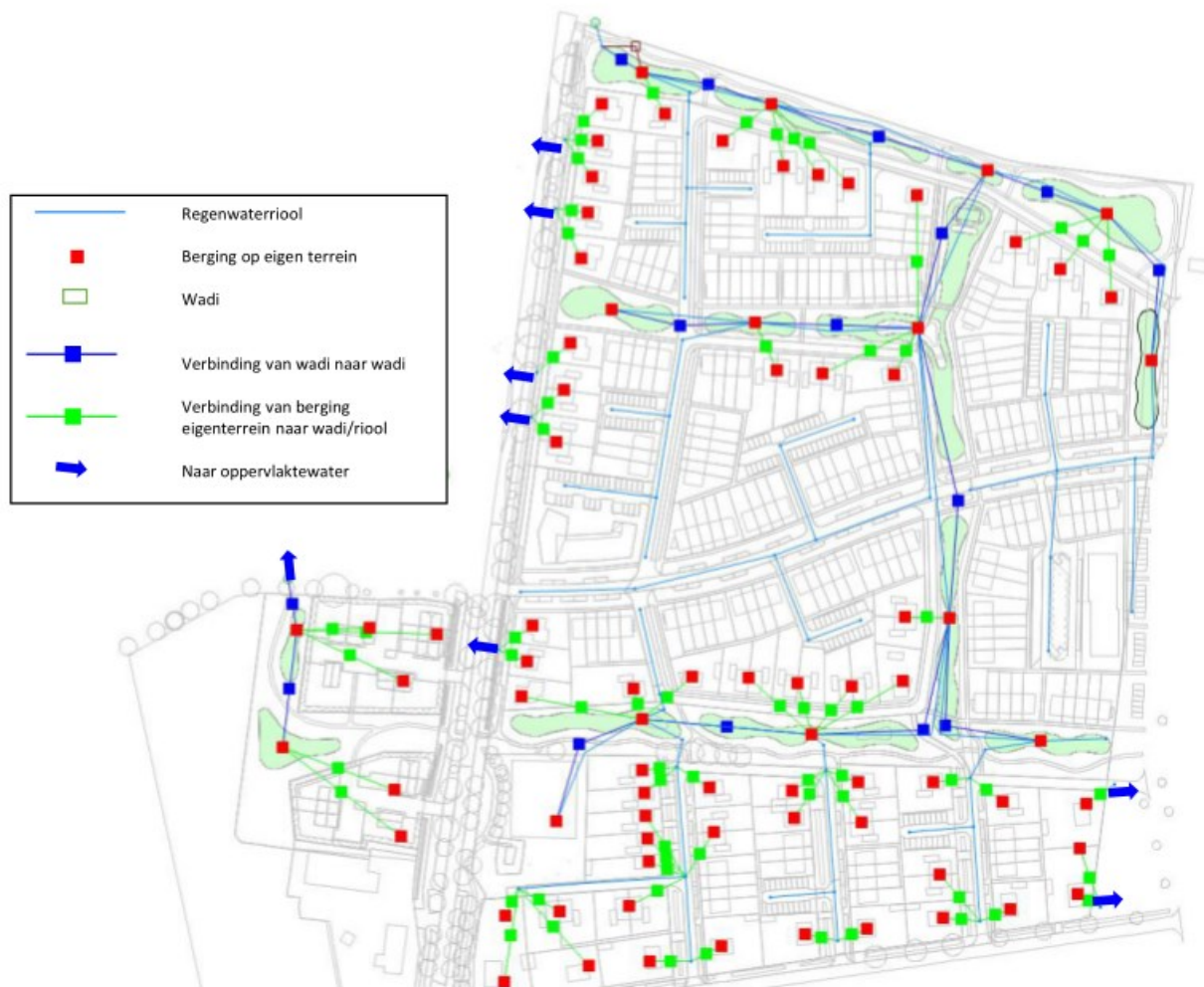
Figuur 4 Totaalmodel InfoWorks met leidingen, wadi's en bergingen op eigen terrein
